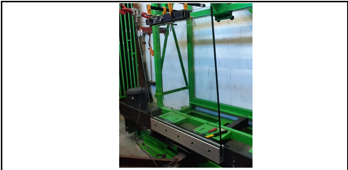
Garde-corps sollicité par la charge d'exploitation P_e
